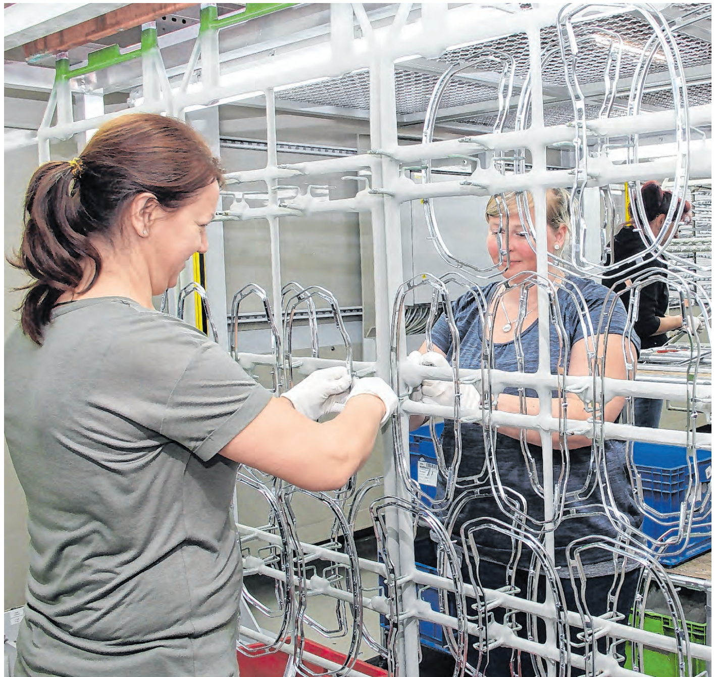
Schon glänzt es: Mitarbeiter der Firma Boryszew entnehmen Zierelemente nach dem Galvanikprozess.
