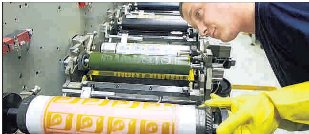
Farb-Test: Ein Mitarbeiter stellt eine Zehn-Farb-Druckmaschine ein.
