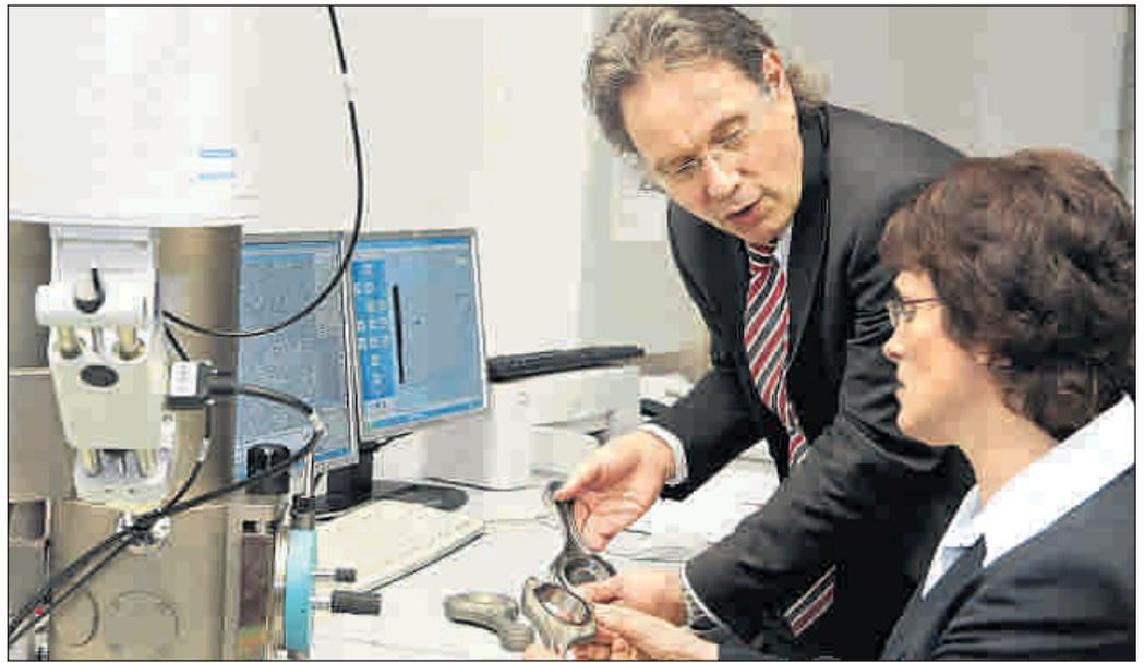
Tests im Labor: Die Mikrostrukturen eines Pleuels aus Titanaluminid werden im Werkstofflabor von Janny Lindemann (l.) und Bernd Viehweger untersucht.
