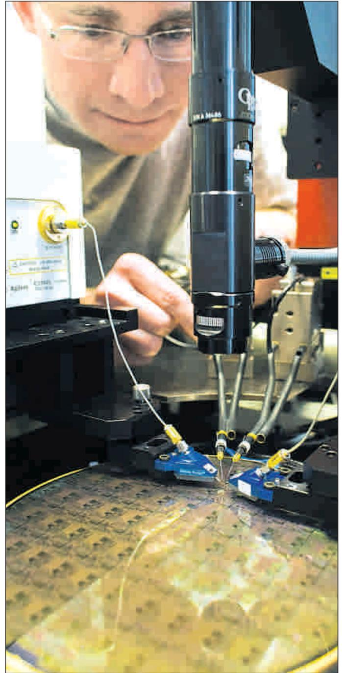
Qualitäts-Kontrolle: Falk Korndörfer testet im IHP Schaltkreise auf einem Silizium-Wafer.
