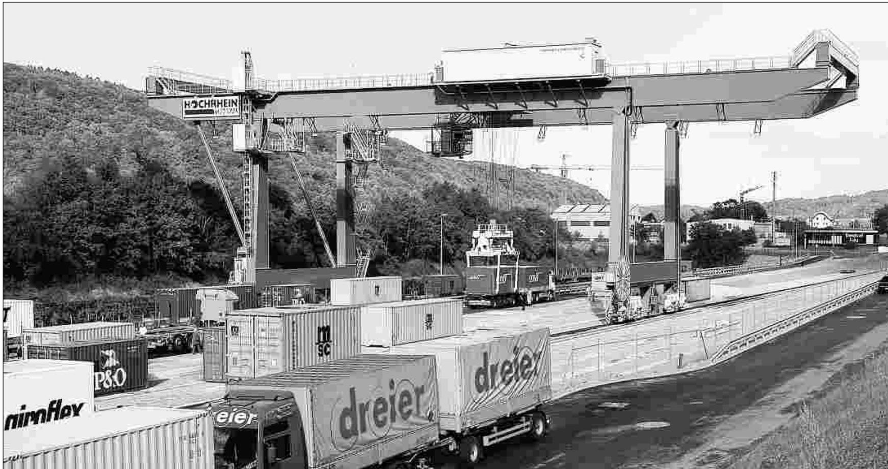
Verladestation in Rekingen in der Schweiz: 56 Tonnen kann dieser Container-Vollportalkran heben – eine vergleichsweise geringe Last. Ardelt fertigt Kräne, die bis zu 150 Tonnen tragen können. Manch hochauferichtetes Modell reckt sich 80 Meter in die Höhe. Foto: Ardelt
