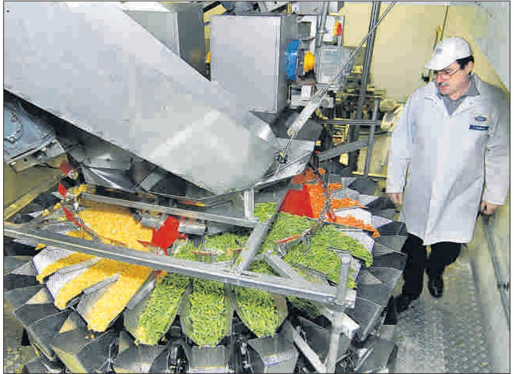
Grammgenaue Gemüse-Mischungen: Thomas Fuhrmann, Produktionsdirektor der Frenzel Oderland Tiefkühlkost GmbH in Manschnow, an der Mehrkopfwaage
