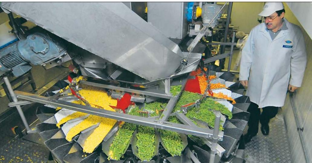
**Grammgenaue Gemüse-Mischungen:** Thomas Fuhrmann, Produktionsdirektor der Frenzel Oderland Tiefkühlkost GmbH in Manschnow, an der Mehrkopfwage.
