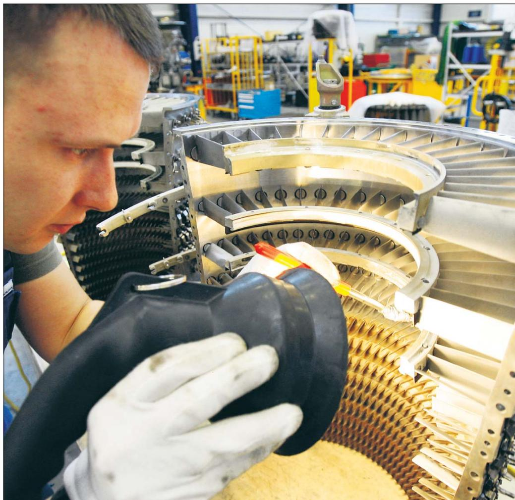
Ein Techniker überprüft das Innere eines CF-34 Flugzeugtriebwerkes in Ludwigsfelde.
