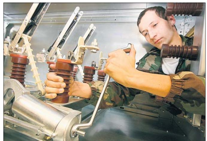
**Alles im Griff:** Maik Winkler, Montagehelfer bei der uesa Schaltanlagen GmbH in Uebigau, beim Zusammenbau eines luftisolierten Mittelspannungsfeldes.
