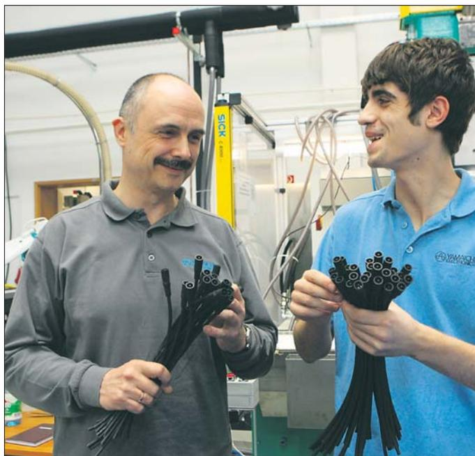
**Hände voll mit Arbeit.** Fertigungsingenieur Olaf Menge und Operator Alexander Dyber (v.l.) kontrollieren Kabel, die in einer Kunststoffspritzmaschine umspritzt wurden.
