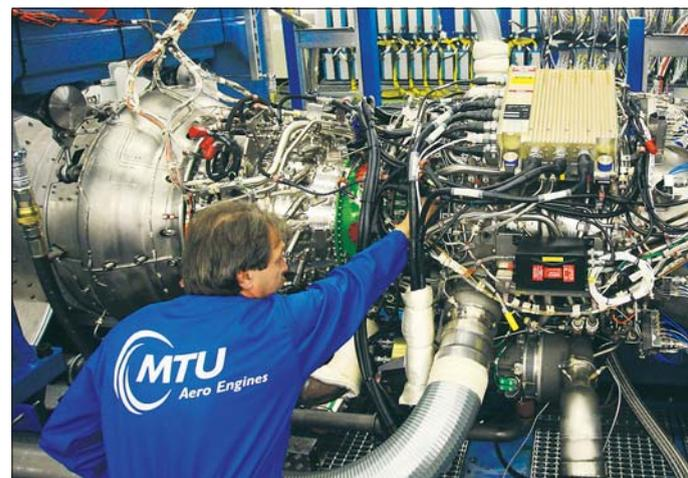
Nach einem Testlauf wird hier ein Triebwerk TP400-D6 für den Militärtransporter Airbus A400M geprüft.
