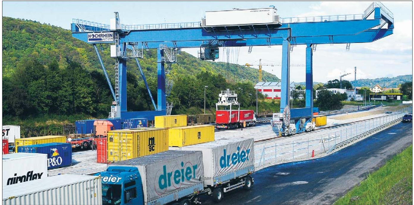
**Verladestation in Rekingen in der Schweiz:** 56 Tonnen kann dieser Container-Vollportalkran heben – eine vergleichsweise geringe Last. Ardelt fertigt Kräne, die bis zu 150 Tonnen tragen können. Manch hochaufrichtetes Modell reckt sich 80 Meter in die Höhe. Foto: Ardelt
