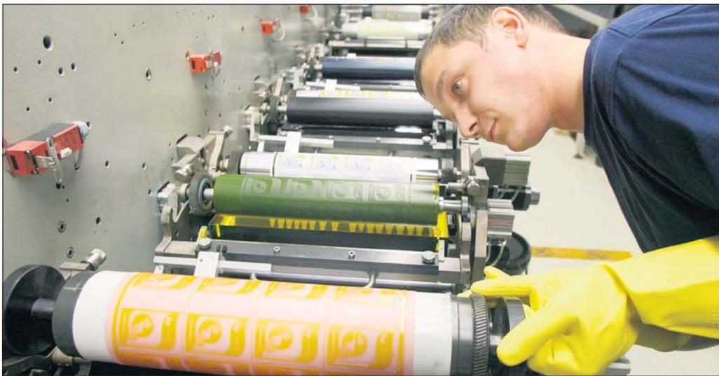
Ein Mitarbeiter der Clever Etiketten GmbH in Hosena arbeitet an einer Zehn-Farb-Druckmaschine.
