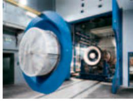
Prüfstand für Industriegasturbinen
