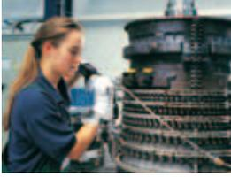
Instandsetzung des Hochdruckverdichters eines CF-34 Triebwerks
