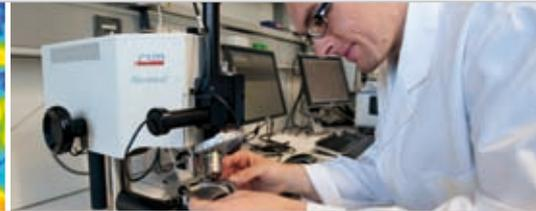
Haftfestigkeitsprüfung als Qualitätskontrolle (Scratch-Test)
